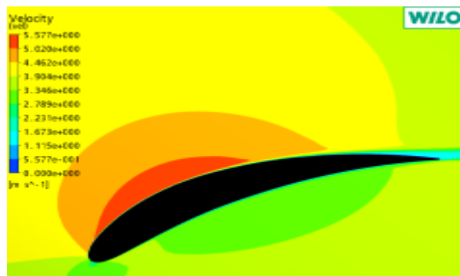
Geschwindigkeitsverteilung auf einem Zylinderschnitt um ein Rührwerksprofil
